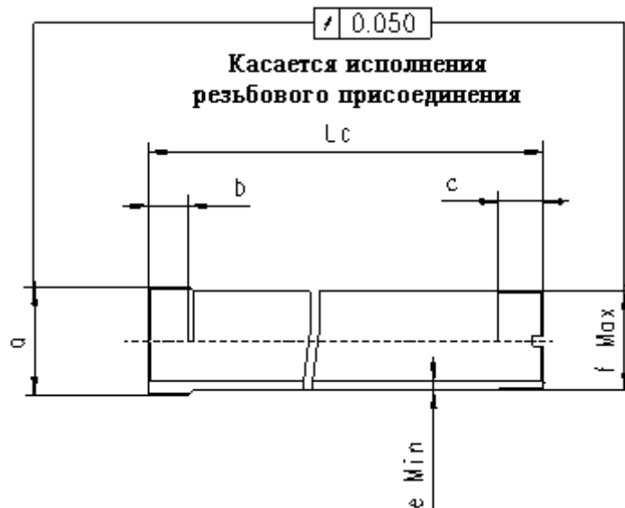
Рис. 7 Размеры тяги для патрона
